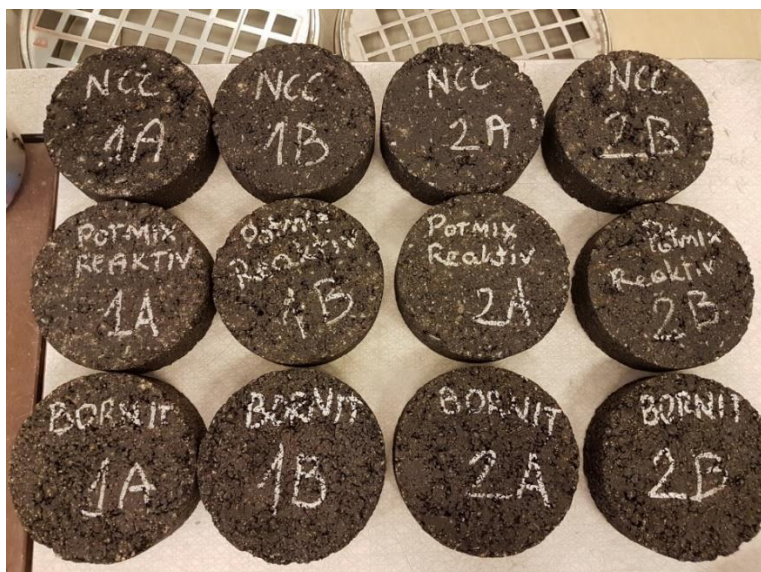
Bild 6. Marshallstampade provkroppar (2x50 slag) förbered till prall testet.
