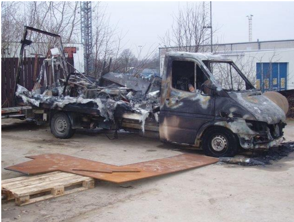
Bild 1. Nedbrunnen borbuss efter olycka med gasolflaska som används till bitumenuppvärmning.
