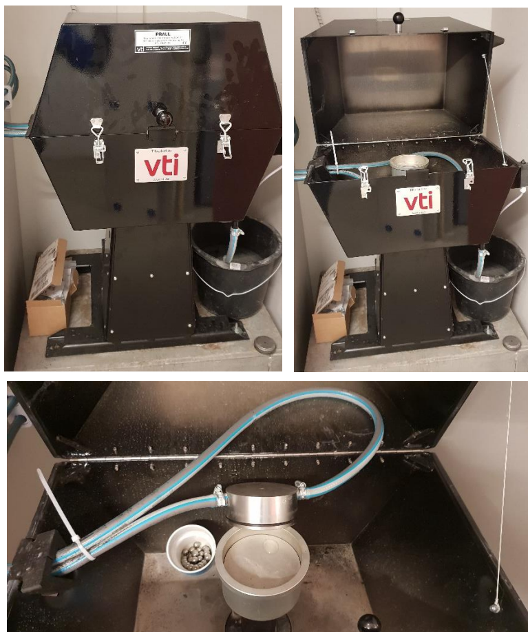
Bild 5. Maskin för bestämning av nötningsmotstånd (prall maskin).
