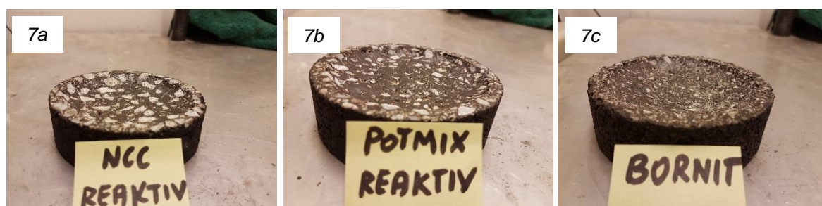
Bild 7. Marshallstampade prover efter prallanalys (utförd på sågade yta). Analyserade kallmassasorter:
