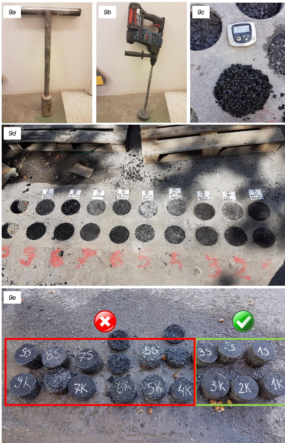
Bild 9. Provtagning av borrhärlar för Kangoostamp/handstamp hålrumsinhåll jämförelse. (9a) Handstamp, (9b) Kangoostamp, (9c) Stoppur – stampningstid 1 minut, (9d) Ø150mm borrhål lagade med olika kallmassasorter och två packningsmetoder (Kangoostamp/handstamp), (9e) Ø100mm provkroppar urborrade från Ø150mm borrhållagningar.
