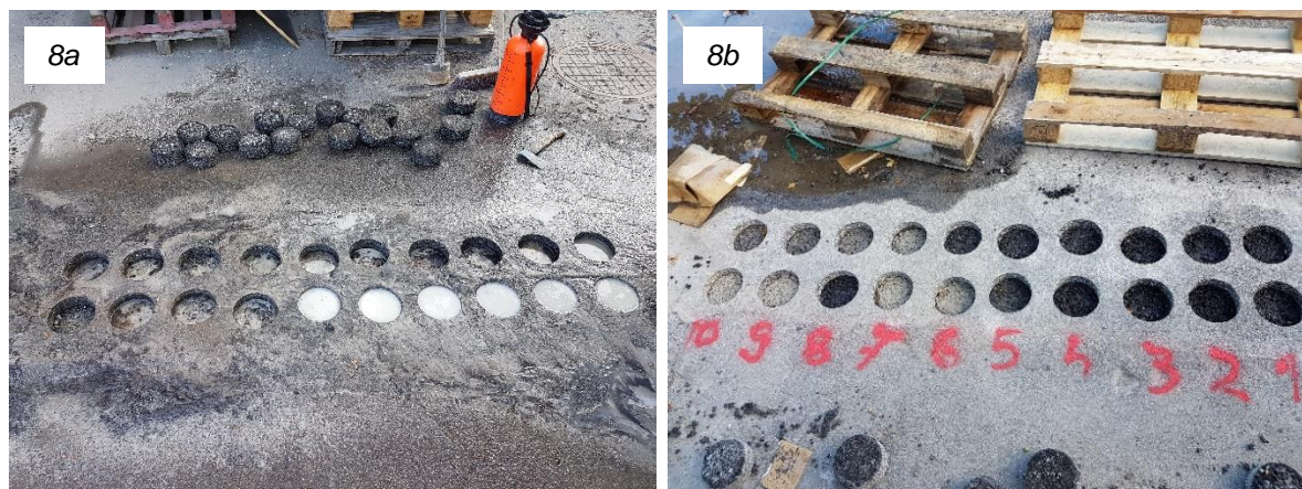
Bild 8. Förberedning av arbetsyta för Kangoostamp/handstamp hålrums halt jämförelse.
