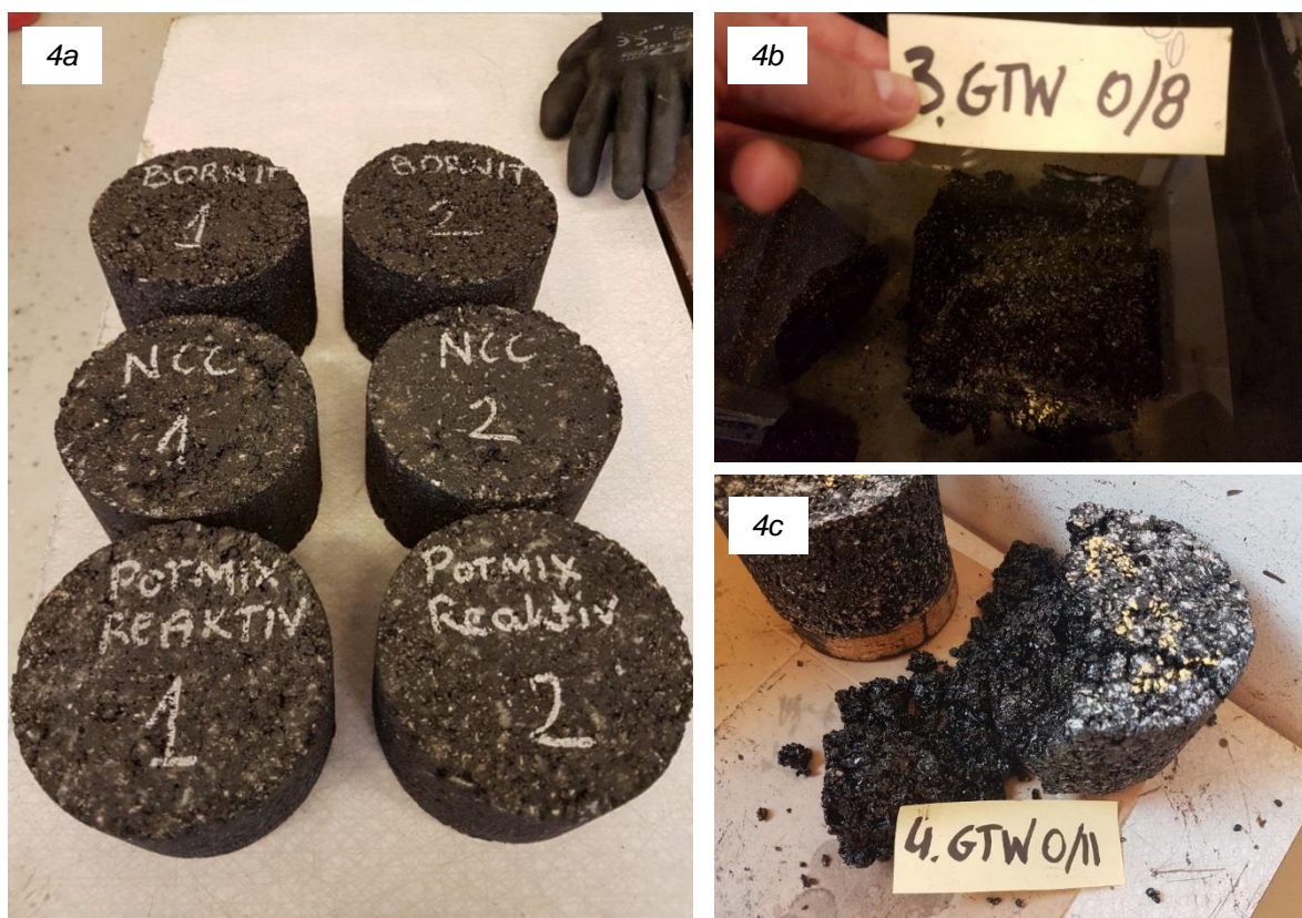
Bild 4. Exempel på Marshallstampade provkroppar (2x50 slag) 4a) Potmix reaktiv , NCC Repasfalt , Bornit Reaktiv Asfalt 40 4b) REaktiv Asfalt (green-tech-works.se) 0/8 4c) REaktiv Asfalt (green-tech-works.se) 0/11
